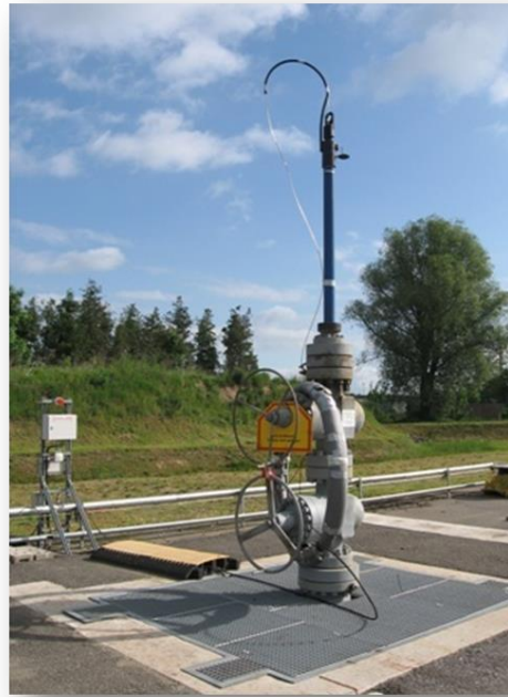
Detektion CO 2 -Ankunft mit Gasmembransensor Patent: US 7,523,680 B2
