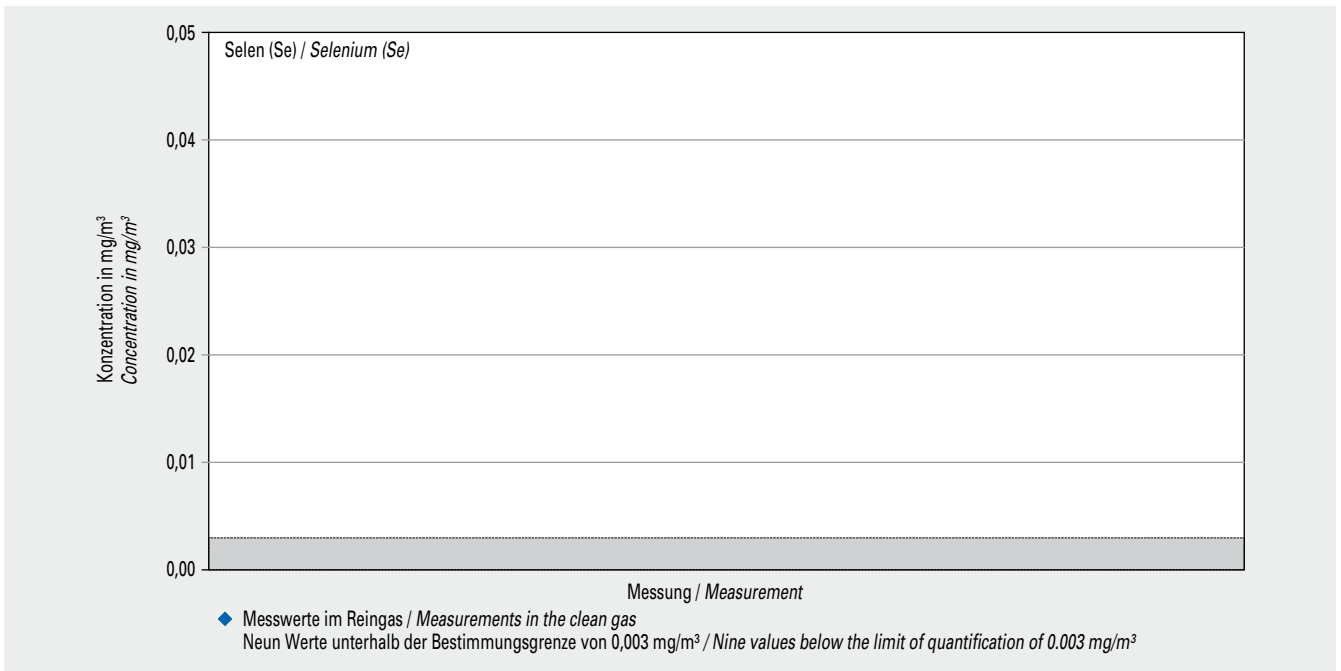
Bild 5-30 Messwerte (Jahr 2018) der Konzentration von Selen (Se) im Reingas von drei Drehofenanlagen Fig. 5-30 Selen (Se) concentration values (year 2018) measured in the clean gas of three rotary kilns
